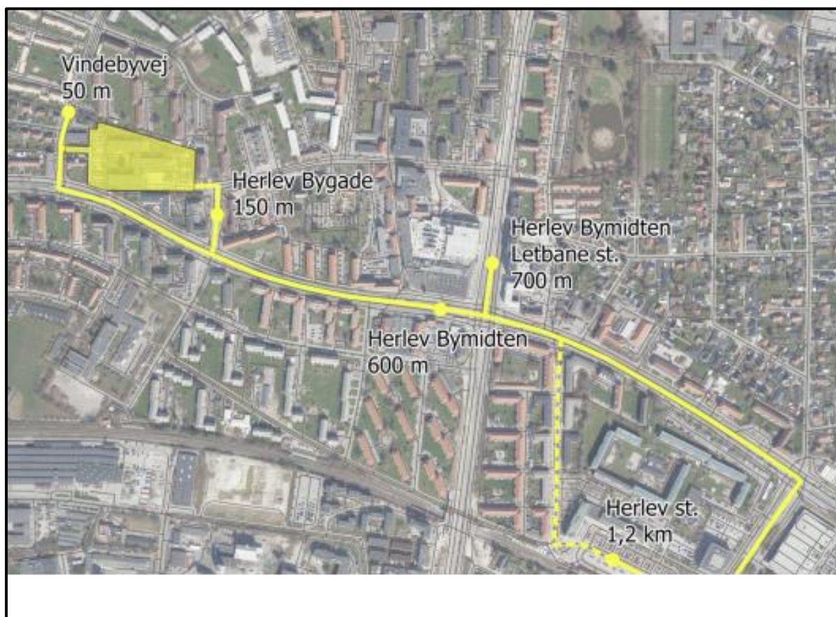
Figur 8.8: Den kollektiv betjening, hvor den kommende letbane station Herlev Bymidte indgår. Afhængig af hvor i projektområdet man bor, er afstanden +/- 75 meter. Den stiplede linje er den korteste rute for de bløde trafikanter.
